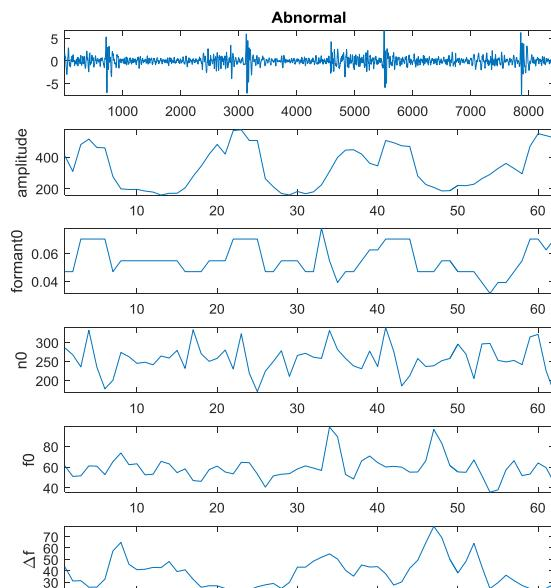
فرکانسی سیگنال و عرض باند مؤثر سیگنال در شکل ۱ با هم مقایسه شده‌اند و همان‌طور که مشخص است، در مقدار میانگین و توزیع تمایز وجود دارد. همچنین، با توجه به شکل توزیع به دست آمده از ویژگی‌های پیشنهاد شده، می‌توان در آینده با استفاده از عملیات‌های دیگری نظیر همبستگی (Correlation)، ویژگی‌های جدیدی از آن‌ها استخراج کرد.
