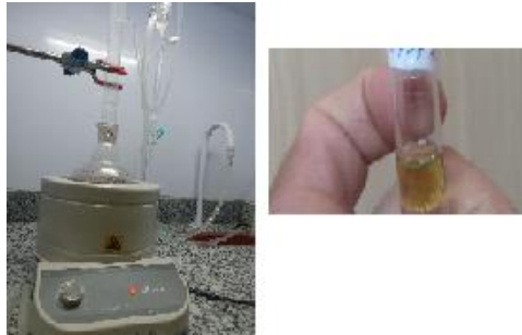
شکل ۴. تصویر انجام اسانس‌گیری با دستگاه شوف بالن و کلونجر
