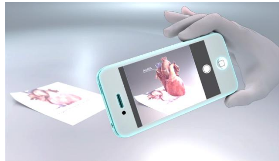
شکل ۲. یک برنامه‌ی کاربردی واقعیت افزوده که با گرفتن گوشی روی کاغذی با تصویری پزشکی، مدلی سه‌بعدی از آن را به کاربر نشان می‌دهد. در AR می‌توان برای هر تصویر از کتاب یا برای مختصات جغرافیایی مشخص، اطلاعات اضافی ارائه نمود.
