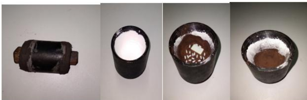
شکل ۲. فرایند پوشش‌دهی نمونه‌ها با بور
