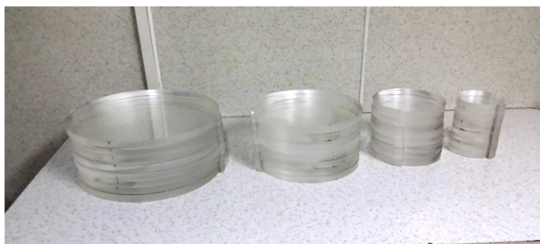
شکل ۱. فانتوم‌های استوانه‌ای به قطرهای ۱۰، ۱۶، ۲۴ و ۳۲ و طول ۱۶ سانتی‌متر
