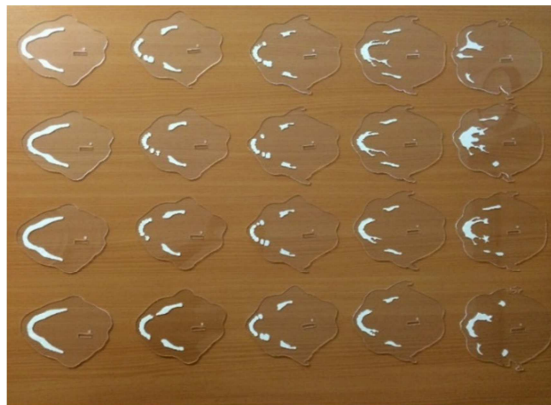
شکل ۲. قالب‌گیری ماده‌ی معادل استخوان در محل‌های برش داده شده
