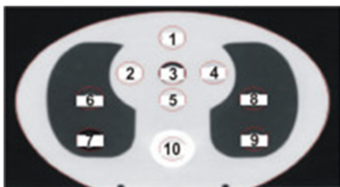
شکل ۱. شمای فانتوم مورد استفاده. حفره‌های ۱، ۲، ۳، ۴ و ۵ برای بافت نرم و ۶، ۷، ۸، ۹ برای بافت ریه و ۱۰ برای نخاع می‌باشد.
