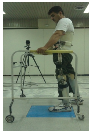
شکل ۳. فرد قطع نخاع در حال تست حرکت با ارتز جدید
