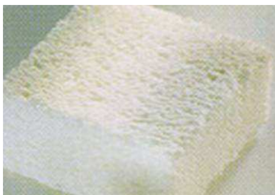
شکل ۲. یک بلوک هیدروکسی آپاتیت- تری کلسیم فسفات؛ این بلوک مکعبی شکل به ابعاد 3 \times 3 \times 3 میلی‌متر و قطر منافذ ۵۰۰ میکرومتر می‌باشد.
