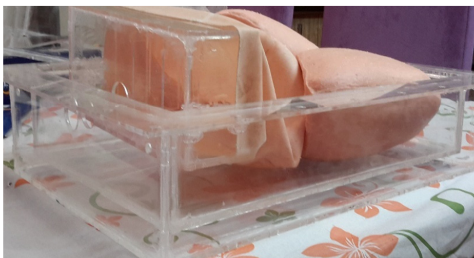
شکل ۷. محفظه‌ی دو جداره‌ی قفسه‌ی سینه و محفظه‌ی نگهدارنده‌ی دیافراگم
