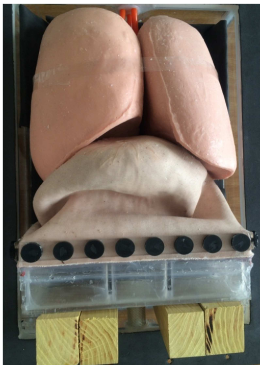
شکل ۶. دیافراگم مصنوعی و موقعیت آن نسبت به ریه‌های سیلیکونی
