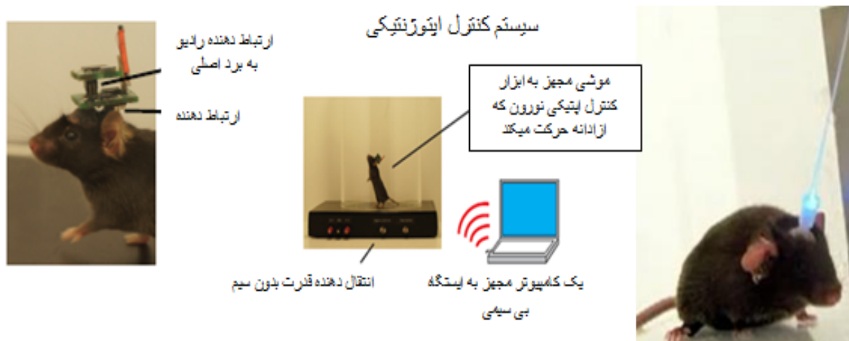
شکل ۲. استفاده از فیبر نوری (با سیم) و روش‌های بی‌سیم در القای تحریکات اپتوزنتیکی (۳۶)
