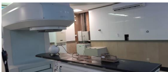
شکل ۱. نحوه‌ی قرارگیری آشکارساز نوترون در محور مرکزی میدان تابش و زاویه‌ی گانتری صفر درجه
